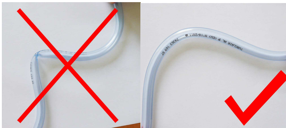
Rys. 28. Zasada układania przewodów ciśnienia.
