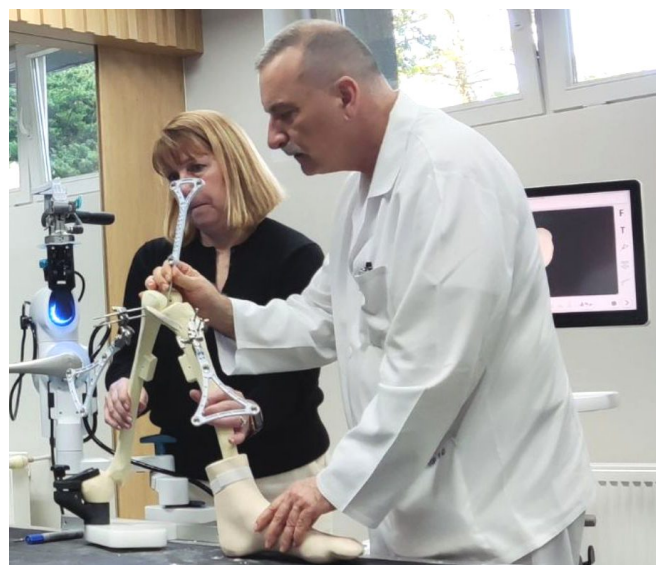
Testowanie robota dedykowanego do wykonywania operacji endoprotezy kolana
